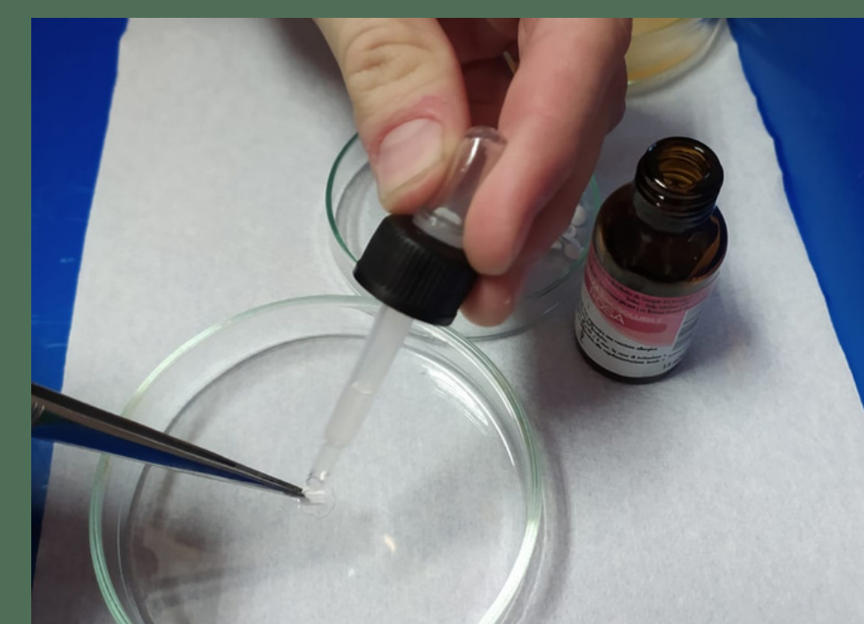
Slika 5 Stavljanje diska (filter-papira natopljenog ispitivanim uljem) u petrijevke
