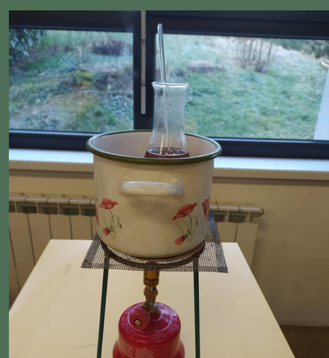
Slika 2 Kuhanje hranjive podloge u vodenoj kupelji
